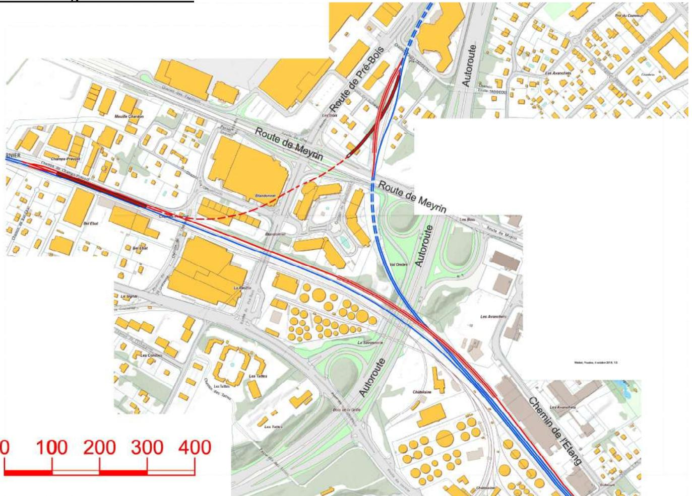
Le raccordement de Blandonnet, entre la ligne de l'aéroport et celle de La Plaine, s'enfonce suffisamment profondément pour passer sous le carrefour Route de Meyrin – Route de Pré-Bois, et aussi sous l'angle du bâtiment du centre commercial de Blandonnet.
