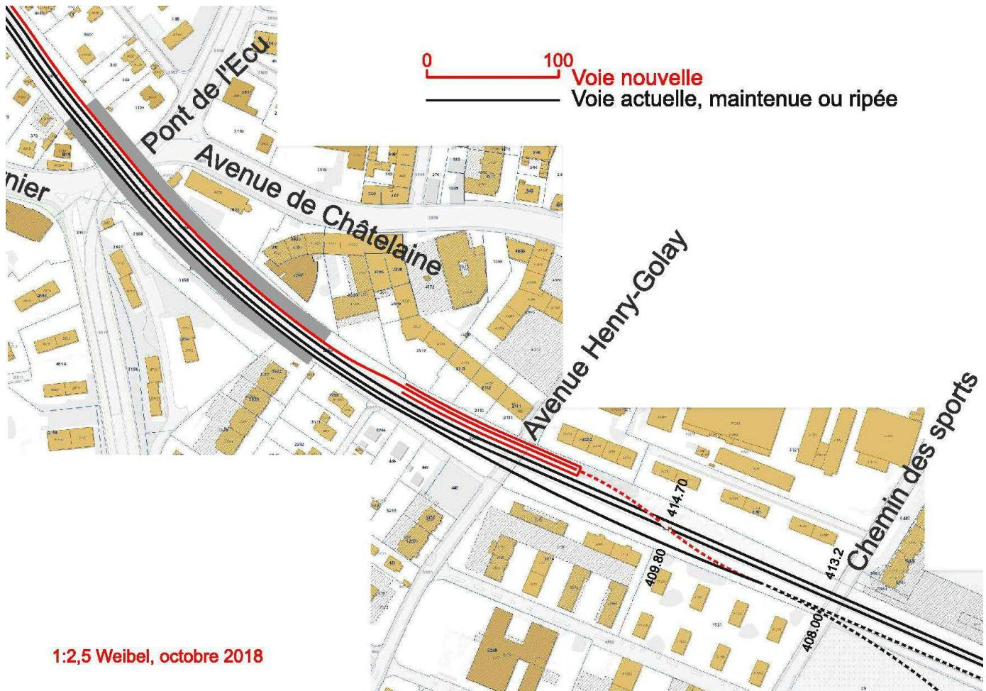
A droite, la bifurcation tunnel de Furet / saut-de-mouton souterrain de 1985. La bifurcation est située profondément 5 mètres en-dessous des voies de la ligne de La Plaine, ce qui permet de réaliser relativement simplement le saut-de-mouton souterrain passant du côté sud des voies au côté nord. La double voie de la ligne de La Plaine peut être surélevée, il suffit de la poser sur un pont provisoire pour creuser le saut-de-mouton souterrain.
