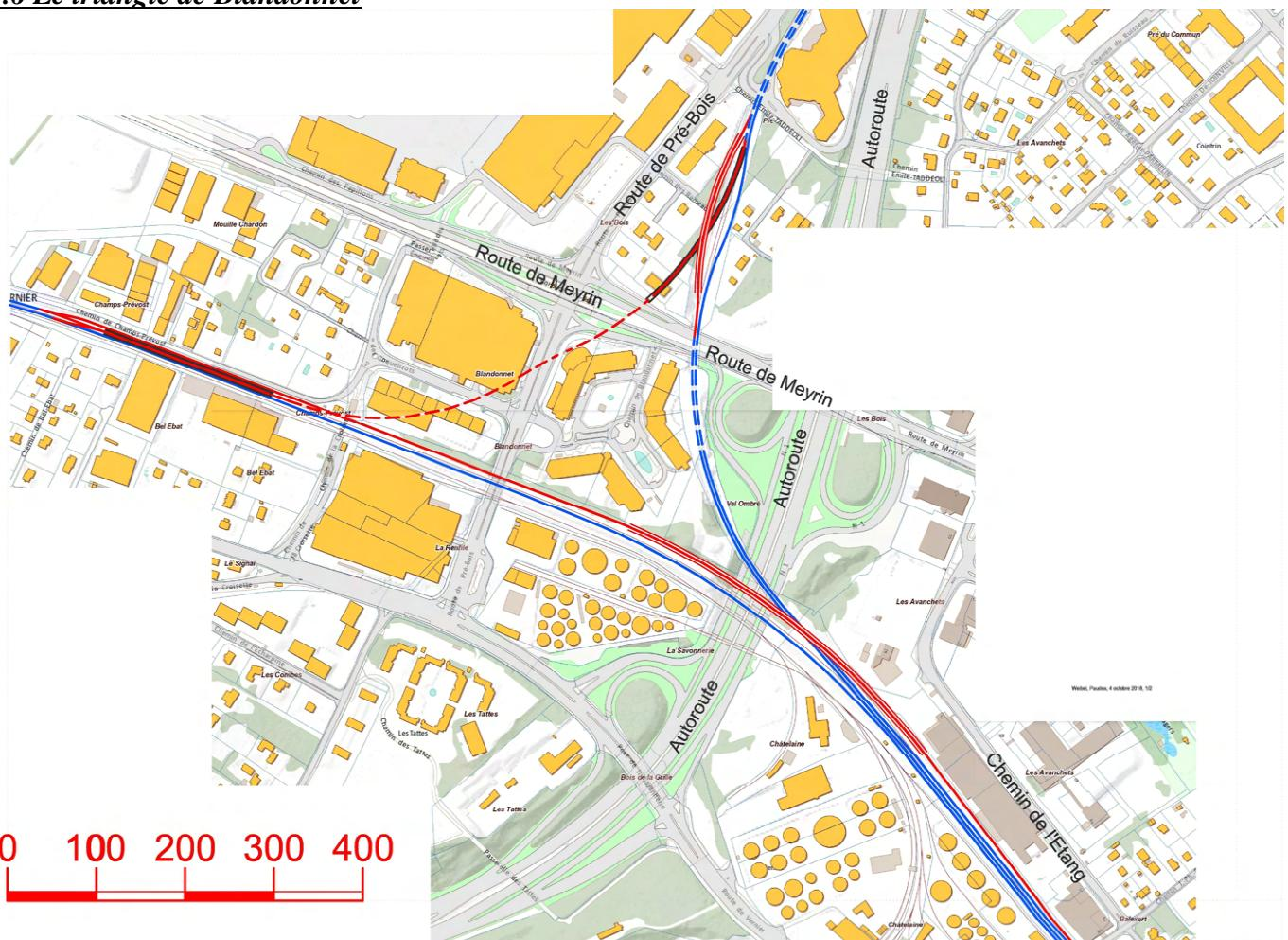
Le raccordement de Blandonnet, entre la ligne de l'aéroport et celle de La Plaine, s'enfonce suffisamment profondément pour passer sous le carrefour Route de Meyrin – Route de Pré-Bois, et aussi sous l'angle du bâtiment du centre commercial de Blandonnet.
