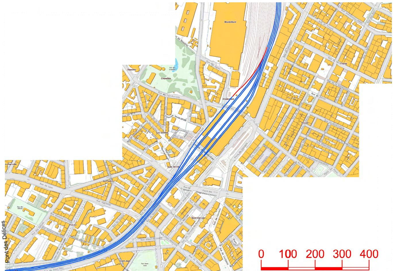
Ce plan indique la principale modification du faisceau de voies nécessaire à Cornavin : le prolongement de l'actuelle voie 8 permettant de rejoindre les voies en direction de Lausanne.
