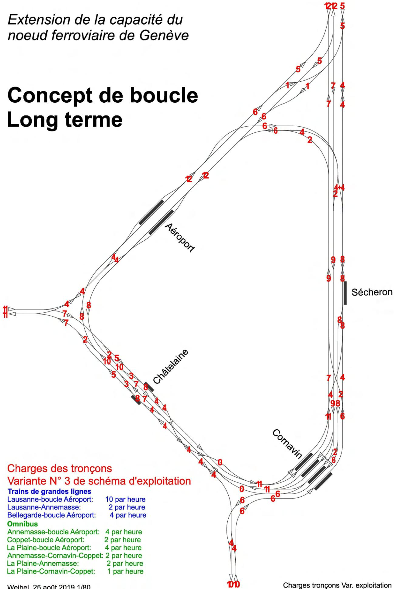
Ce schéma représente le réseau des voies ferrées, les flèches indiquent le sens dans lequel circulent en principe les trains sur chaque voie, les chiffres rouges indiquent la fréquence horaire de trains à l'endroit où ils sont écrits.
