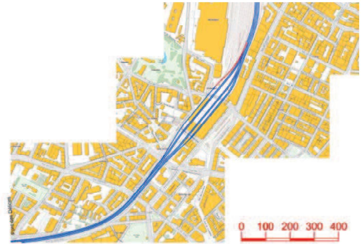
Ce plan indique la principale modification du faisceau de voies nécessaire à Cornavin : le prolongement de l'actuelle voie 8 permettant de rejoindre les voies en direction de Lausanne.
