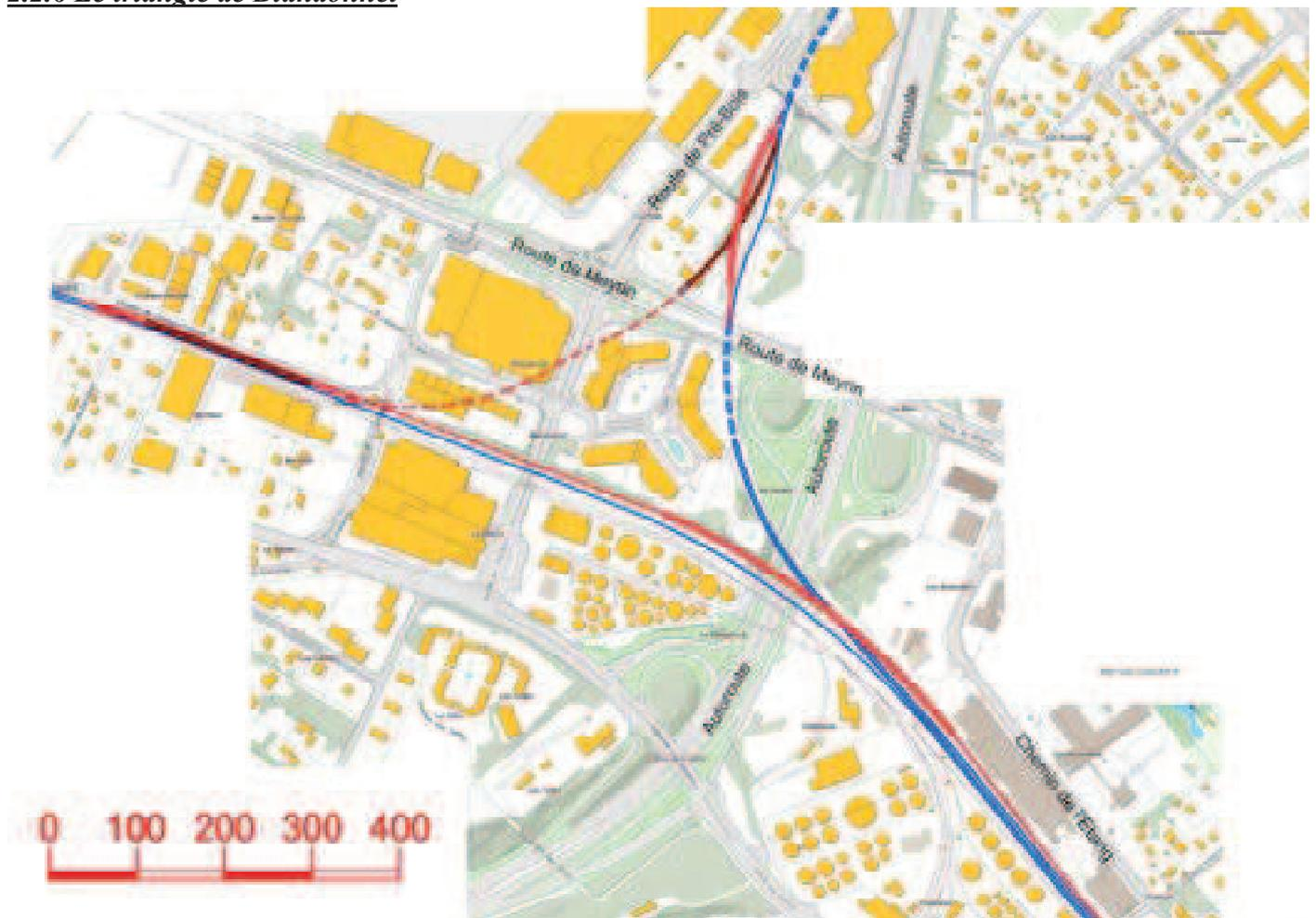
Le raccordement de Blandonnet, entre la ligne de l'aéroport et celle de La Plaine, s'enfonce suffisamment profondément pour passer sous le carrefour Route de Meyrin – Route de Péré-Bois, et aussi sous l'angle du bâtiment du centre commercial de Blandonnet.
